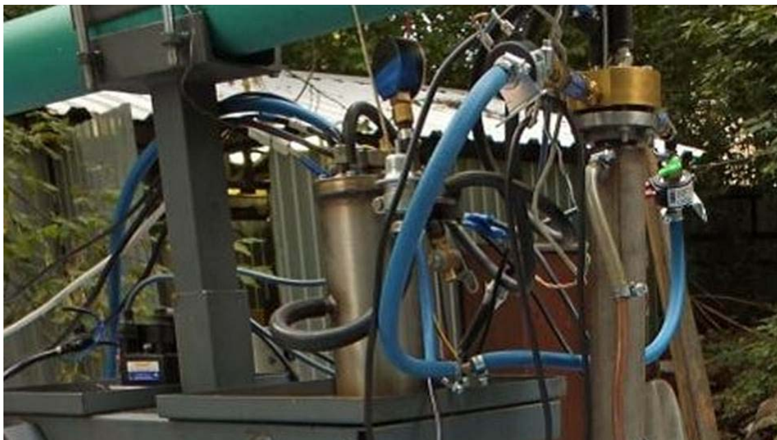
Рис. 6. Экспериментальный образец прямооточного импульсно-детонационного гидрореактивного двигателя на тягоизмерительной раме Фото: Сергей Фролов
