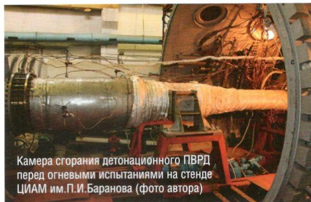
Камера сгорания детонационного ПВРД перед огневыми испытаниями на стенде ЦИАМ им.П.И.Баранова (фото автора)
