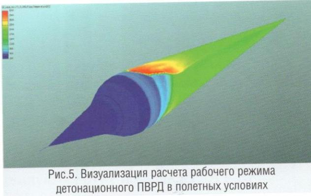
Рис.5. Визуализация расчета рабочего режима детонационного ПВРД в полетных условиях
