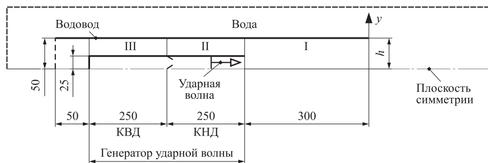
Рис. 1 Схема устройства для расчета передачи импульса от ударной волны к пузырьковой среде. Размеры указаны в миллиметрах
