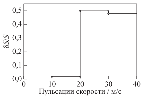
Рис. 8 Пример функции распределения пульсаций скорости в предпламенной зоне в виде зависимости доли общей площади предпламенной зоны \delta S/S (ограничена белыми линиями на рис. 7), в которой имеются пульсации скорости в выбранном интервале амплитуд
