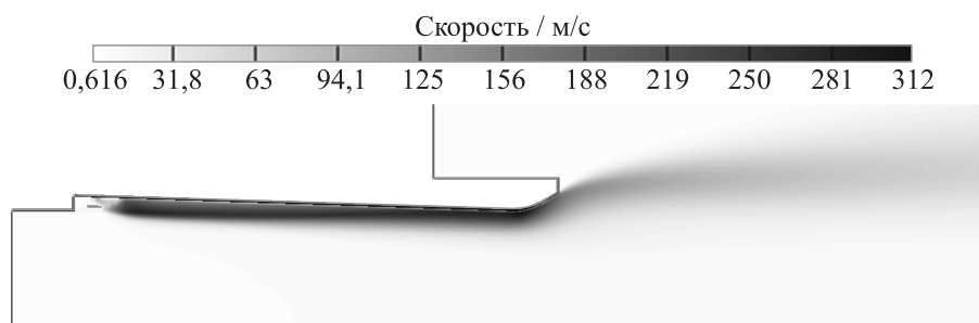
Рис. 3 Расчетное поле скорости газа при горячей продувке каверны под днищем судна с избыточным давлением подачи топливной смеси, равным 20 кПа
