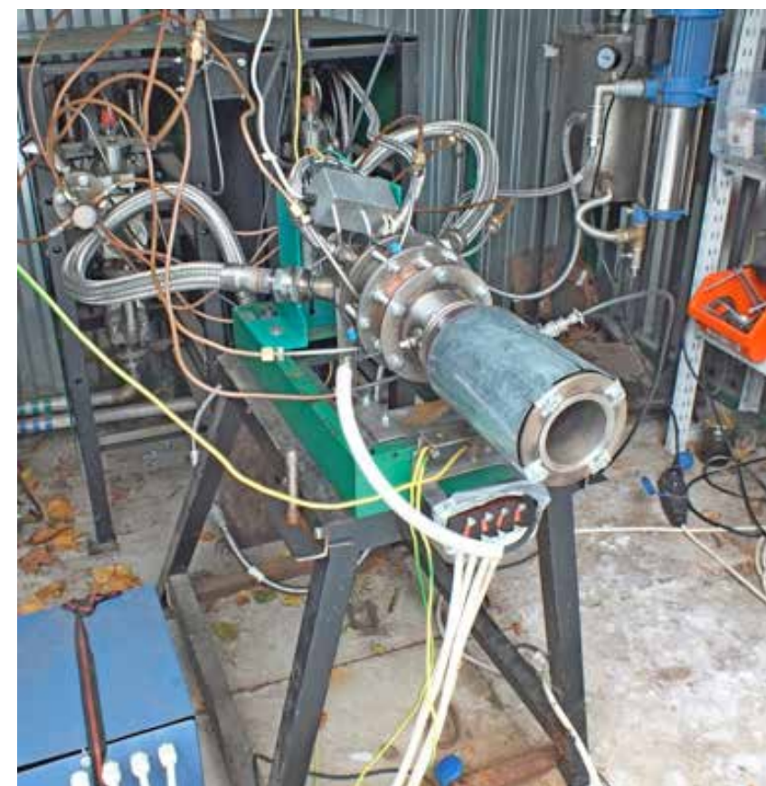
—Демонстрационный образец ДРД, установленный на испытательном стенде
