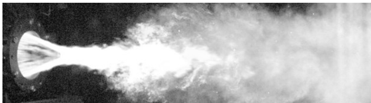
Рис. 4 Фотография выхлопной струи ДРД в одном из огневых испытаний
